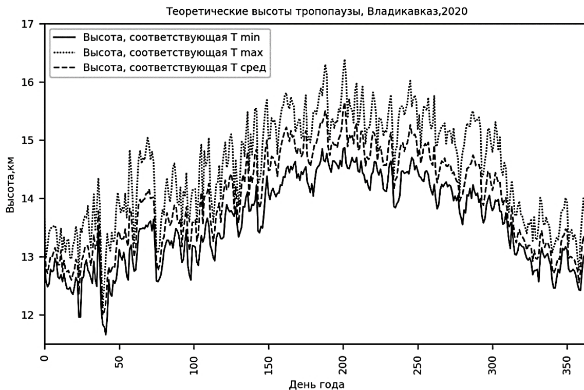
Рис. 5. Сезонная изменчивость высоты, км, острых минимумов адиабаты (1), вычисленных для минимальных (сплошная кривая), максимальных (кривая с тонким пунктиром) и средней (пунктирная кривая) температур на высоте 2 км по данным MERRA-2 для Владикавказа за 2020 г. / Fig. 5. Seasonal height variability, km, of sharp adiabatic minima (1) calculated for the minimum (solid curve), maximum (thin curve) and average (dashed curve) temperatures at a height of 2 km according to MERRA-2 data for Vladikavkaz for 2020
